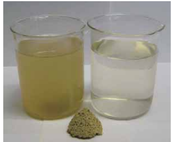
Εικ. 3. Αριστερά: Αρχικό αστικό λύμα, Δεξιά: Διαυγές νερό μετά την κατεργασία με τον ΕΛΦΥΖΕ, Κέντρο: Άοσμη και συνεκτική ζεο-λυματολάσπη.
