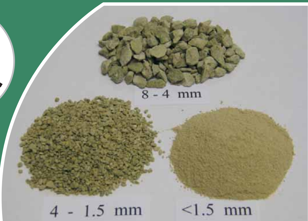
Εικ. 1. Ο ΕΛΦΥΖΕ σε τρεις βιομηχανικές κοκκομετρίες
